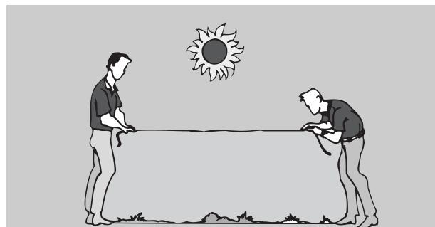
Al medir la longitud entre dos puntos, en días calurosos, la cinta métrica se dilata debido a la fuerte temperatura, luego se cometerá un error de medición.
